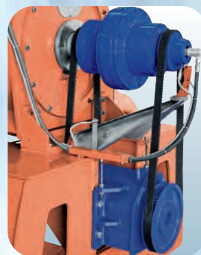
Particolare Roto-variatore e riduttore Detail of Roto-variator and reduction gear Vue du Roto-variateur et du réducteur
