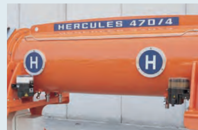
Centraline elettroniche di lubrificazione centralizzata dei cuscinetti di banco e del raschiafango. Electronic control boxes for centralised lubrication of main bearings and sludge scraper. Pilotage électronique des centrales de graissage des roulements principaux et du racleur.
